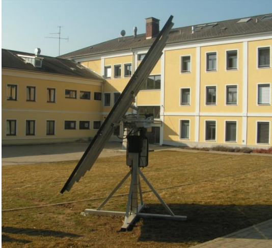
9m 2 Suntracker 2000R/ 2kWp
