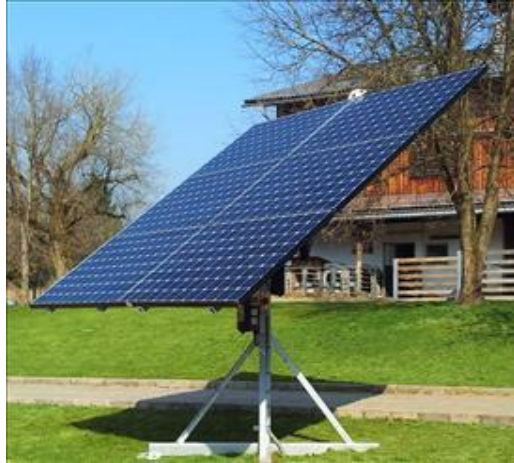
9m 2 Suntracker 2000R/ 2kWp
